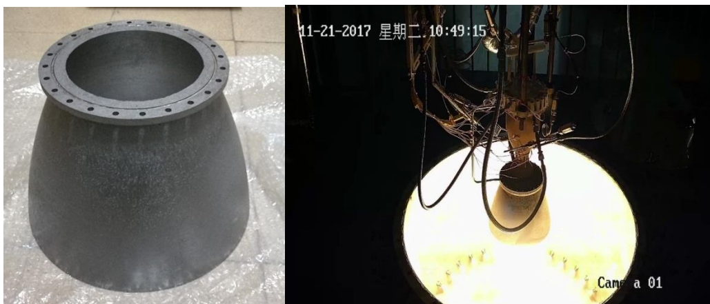
图 3 （a）C/SiC 复合材料尾喷管 （b）热防护考核试验
